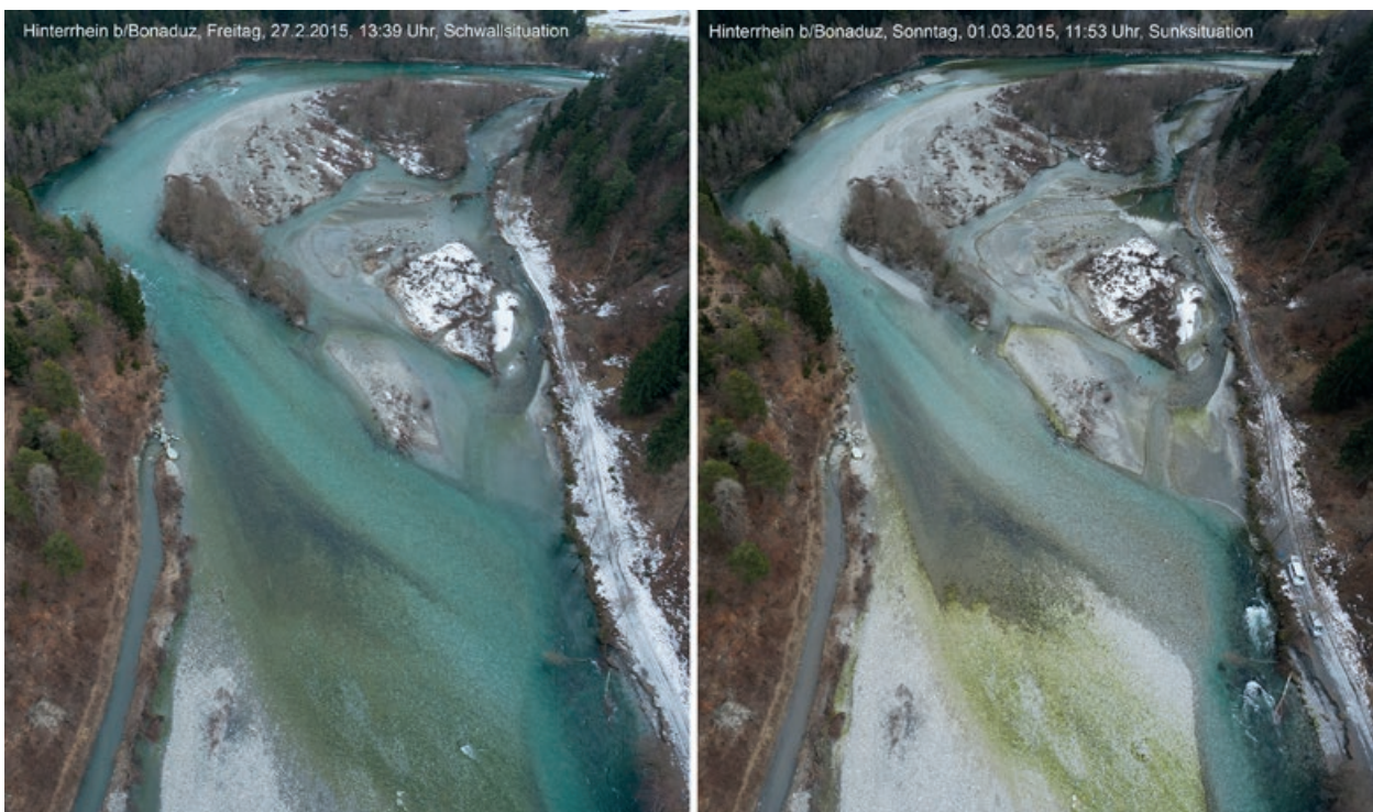
Abb. 8: Schwall-Sunk-Szenario in der Bonaduzer Au am Hinterrhein. Bei hohen Schwallamplituden aus verschiedenen Rückgaben (Albula-Sils i.D., Hinterrhein-Rothenbrunnen) kommt es zwischen Schwall und Sunk zu Wasserspiegelschwankungen bis über 1 m. Dabei werden entsprechend grosse Gerinneflächen benetzt und fallen danach wieder trocken. Fotos: HYDRA 2015 ©.
