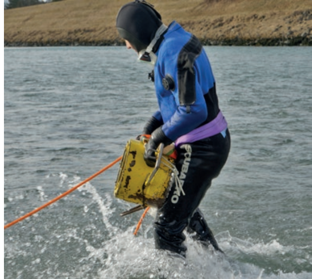
Abb. 9: Links: Probenahme im Stau Reichenau in 7,2 m Tiefe. Oben: Der ca. 25 kg schwere Sampler wird mit den Zähnen nach unten in das Substrat gedreht. Durch eine Öffnung an der Oberseite lässt sich das Substrat aufwühlen und die Probe in den Netzsack an der Seite befördern. Fotos: HYDRA 2015 ©.
